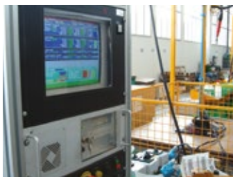
Kontrola kvality, testuje se 100 % výrobků včetně archivace dat
